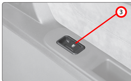
Fig. 109 - Detalle de la puerta del acompañante: mando para la ventanilla.
