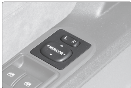
Fig. 118 – Selector y botón de ajuste – Puerta del conductor.
