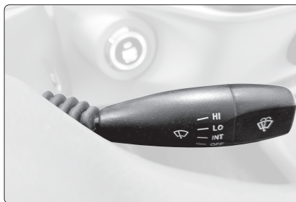
Fig. 117 - Palanca del limpiaparabrisas e la versión Único.
