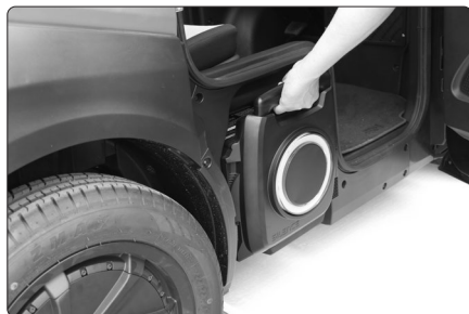
Fig. 135 - Extracción de la batería
