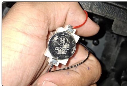
Fig. 55 - Polaridad de la pila.
