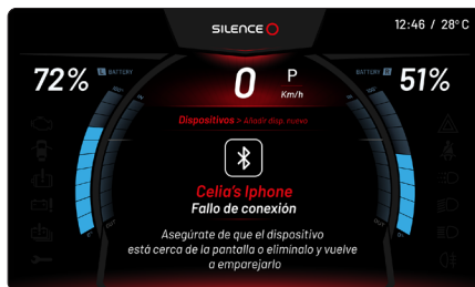
Fig. 64 - Fallo al enlazar el dispositivo seleccionado.
