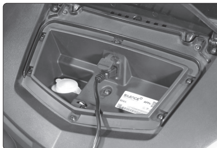
Fig. 130 - Punto de conexión al vehículo.
