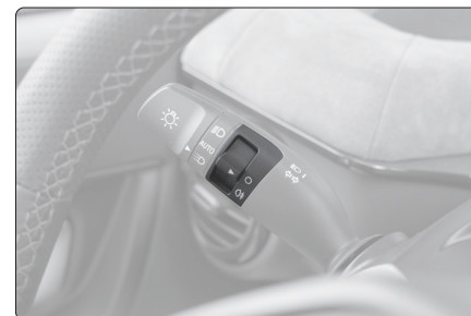
Fig. 111 - Mando de luces - Situado en el lado izquierdo del volante.
