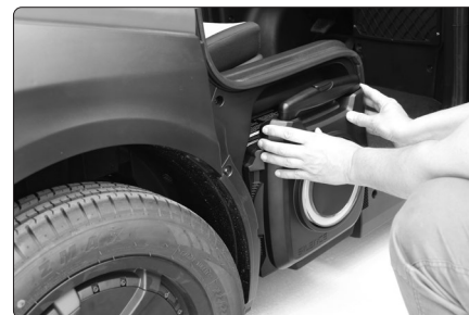
Fig. 137 - Introducción de la batería
