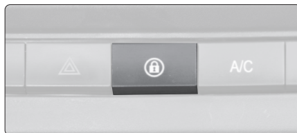
Fig. 45 - Botón para accionar el bloqueo/desbloqueo de las puertas.
