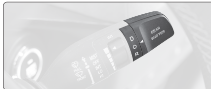
Fig. 31 - Selector de marchas - Situado en el extremo de la palanca del lado derecho, tras el volante.
