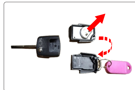
Fig. 101 - Compartimento de la pila.
