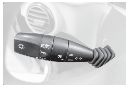
Fig. 113 - Palanca de intermitentes y de luz de carretera en la versión Único.
