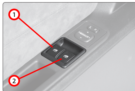
Fig. 108 - Detalle de la puerta del conductor: mandos para las ventanillas.
