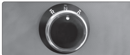
Fig. 32 - Selector de marchas - Situado en el centro por encima de la consola.
