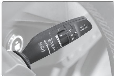
Fig. 116 - Mando limpiaparabrisas - Situado en el lado derecho del volante.
