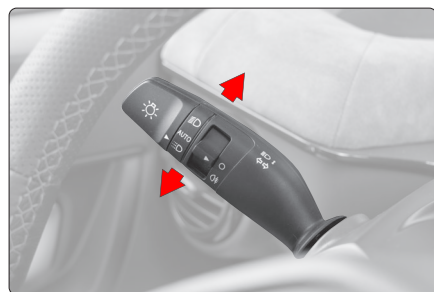
Fig. 28 - Mando de luces - Situado en el lado izquierdo tras el volante.
