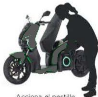
Acciona el pestillo Extrae el Battery Pack
