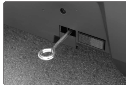
Fig. 16 - Col·locació de l'argolla en la part del darrere.
