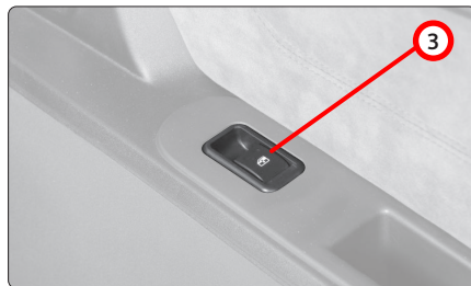
Fig. 102 - Detall de la porta de l'acompanyant: comandament de l'alçavidres.
