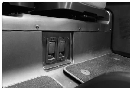
Fig. 124 - Palanques de desbloqueig de bateries.
