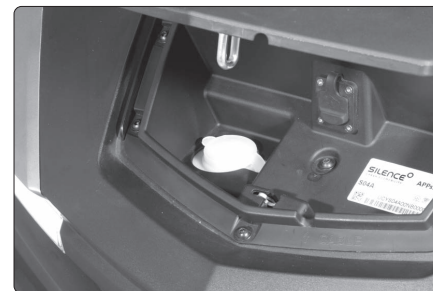
Fig. 25 - Tap del dipòsit.
