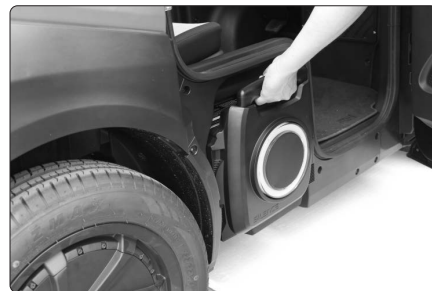
Fig. 125 - Extracció de la bateria.
