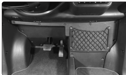
Fig. 18 - Ubicació de la caixa de fusibles.
